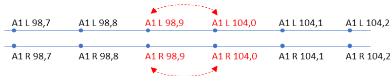
Figuur 10 Voorbeeld A1: Hectometersprong: 99.0 = 104.0. De hectometrering van A1 Rechts loopt na 98.9 niet op naar 99.0 maar verspringt naar 104.0. En op gelijke wijze een overgang bij A1 Links.
